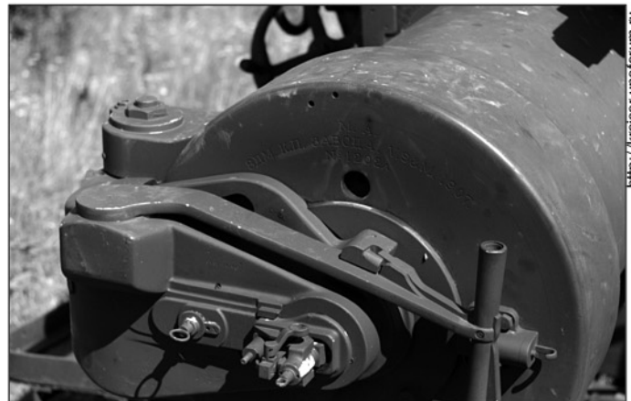
Последний сохранившийся ствол 8-дм./50 клб орудия. На стволе маркировка «М.А.» — «морская артиллерия», ствол изготовлен в 1907 г. заводом Виккерса, буква «а» в номере 1202а относится к орудиям английского производства. Куйвасаари, 2014 г. На фото внизу — увеличенный фрагмент
