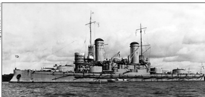
Восемь 8-дм./50 клб орудий в 1912 г. было установлено в двухорудийных башнях и 6 в казематах на линейном корабле «Андрей Первозванный». 1914-15 гг.
