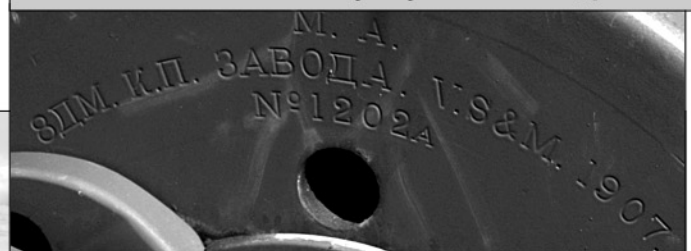
Последний сохранившийся ствол 8-дм./50 клб орудия. На стволе маркировка «М.А.» — «морская артиллерия», ствол изготовлен в 1907 г. заводом Виккерса, буква «а» в номере 1202а относится к орудиям английского производства. Куйвасаари, 2014 г. На фото внизу — увеличенный фрагмент
