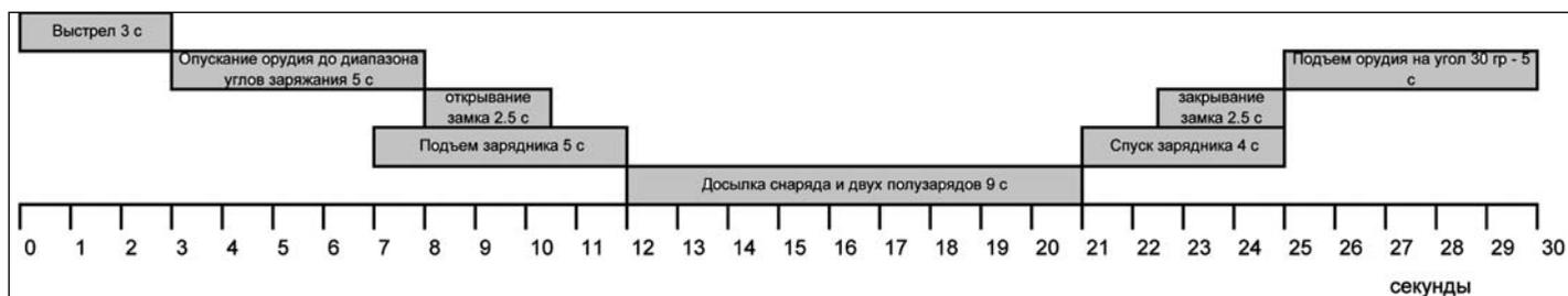
**Цикл стрельбы 14-дм./52 клб береговой башенной установки при максимальном угле возвышения +30°**
